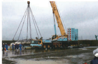
2015年9月、北九州空港沖で発見され、苅田港に引航されたクジラの死骸の撤去風景。クジラの体長は16.3m、重量は33トン。これを載せるための架台が20トン、計53トンという重さを吊り上げるべく、小山が所有する400トン大型クレーンが投入された
