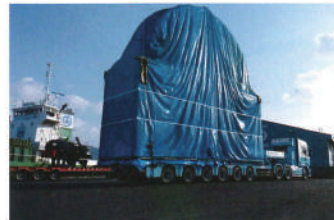
長さ10.0m、幅5.0m、積付高13m、重量52トンという大型プラント製品の輸送風景。6軸式トレーラーを保有しているのは、九州地区において小山だけ。写真からも分かるように重心が非常に高いため、ローリングに気を配りつつ慎重な輸送作業が行われた
