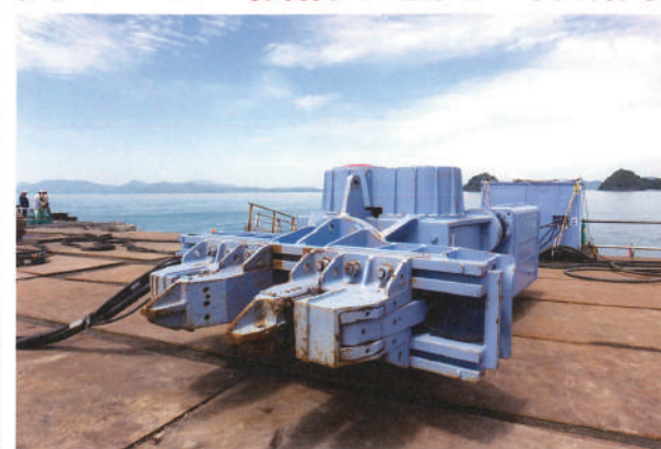
鋼管を地面に打ち込むための電動式大型ハンマー。起動・停止時に生じる、共振振動をゼロにする可変モメント機構を搭載
