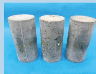
根固め球根のコア供試体の一軸圧縮試験の結果、セメント改良体が最大で38.5MPaという高い強度を有していることを確認しました。
